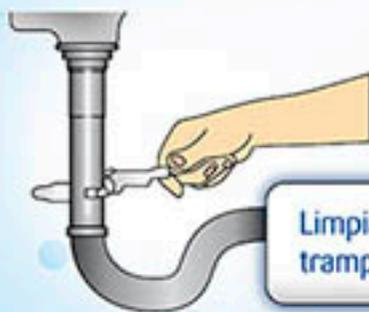
Limpia con regularidad las trampas y sifones de la tubería.
